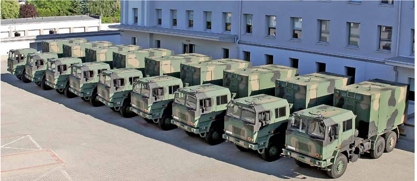
Zintegrowane Węzły Teleinformatyczne w wersji kontenerowej (w większości będące ukończeniem HMS Jaśmin – systemu zarządzania walką szczebla operacyjnego i taktycznego) – kompleksowe rozwiązania C4ISR wchodzące w skład platformy Jaśmin , wdrożone i z powodzeniem eksploatowane od 2006 r. w Siłach Zbrojnych RP.
