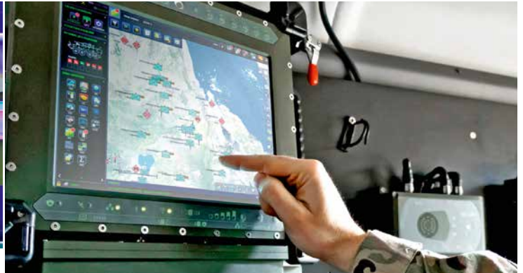
Przykładowe wyposażenie BMS Jaśmin z oprogramowaniem systemu zarządzania walką batalionu, kompanii, plutonu i drużyny (BMS C3IS Jaśmin ), zainstalowane w pojeździe.
