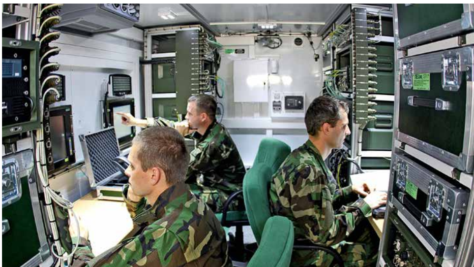
Przykładowe wyposażenie Węzłów Teleinformatycznych w wersji kontenerowej z oprogramowaniem systemu zarządzania walką (HMS C3IS Jaśmin ) – widok wnętrza aparatowni ze stanowiskami operatorskimi.
