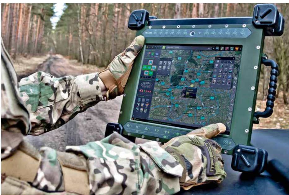
Komputerowy Terminal Taktyczny T12" – jeden z najnowocześniejszych i najodporniejszych w świecie, militarny mobilny komputer taktyczny platformy Jaśmin , przeznaczony m.in. do obsługi oprogramowania systemu zarządzania walką na wszystkich szczeblach dowodzenia – Systemu Wspomagania Dowodzenia C3IS Jaśmin .
