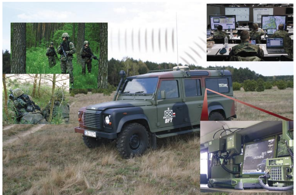
Battlefield Management System – BMS JAŚMIN to system przeznaczony do działania na poziomie taktycznym w obrębie wozów bojowych i dowódczo bojowych. BMS JAŚMIN powstał na bazie mobilnej platformy teleinformatycznej JAŚMIN z jego oprogramowaniem Systemem Wspomagania Dowodzenia C3IS JAŚMIN. BMS JAŚMIN jest przystosowany do zastosowania w mobilnych systemach dowodzenia na poziomie taktycznym z uwzględnieniem radiowych środków łączności.
