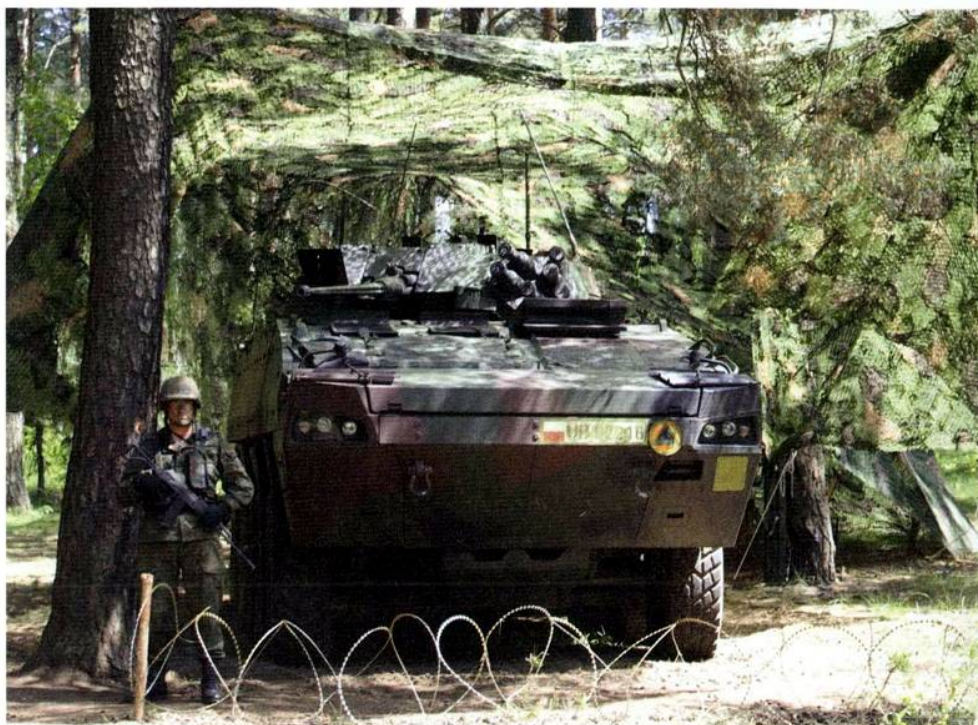
Zamaskowany w pobliżu stanowiska dowodzenia wóz dowódczo-bojowy dowódcy batalionu zmotoryzowanego. Wóz w założeniu ma służyć dowódcy do poruszania się w strefie przyfrontowej, bez tracenia możliwości dowodzenia oddziałami
