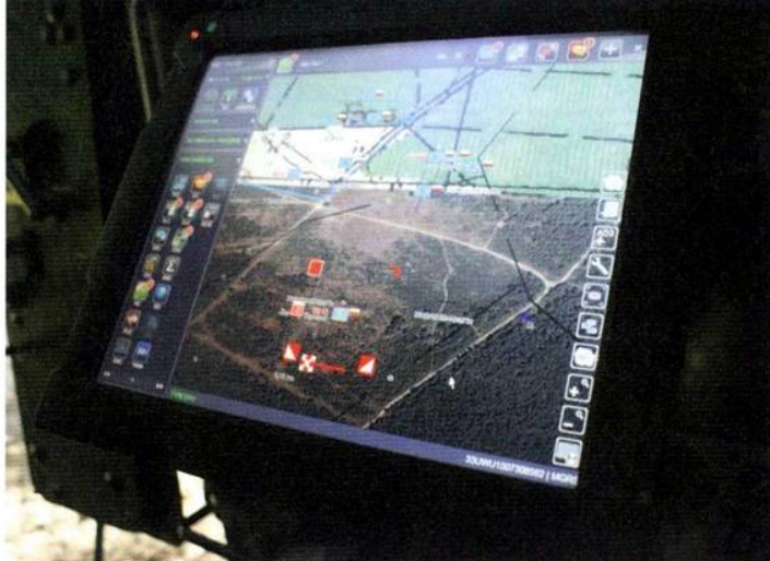
Interfejs systemu C3IS Jaśmin (BMS Jaśmin-Fonet) jest prosty i intuicyjny. Użycie ekranu dotykowego ułatwia instalacje terminalu, znika konieczność szukania dodatkowego miejsca na klasyczne kontrolery (mysz lub trackball i klawiaturę)
