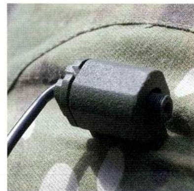
Zamocowana na hełmie kamera wideo umożliwia transmisję ruchomego obrazu wysokiej jakości (system C3IS Jaśmin ma pełną obsługę transmisji wideo), medium transmisyjne zapewnia radiostacja szerokopasmowa ITT Spearnet. Pamiętać należy jednak o ograniczonym zasięgu radiostacji szerokopasmowych (w terenie zalesionym są to zasięgi rzędu setek metrów).
