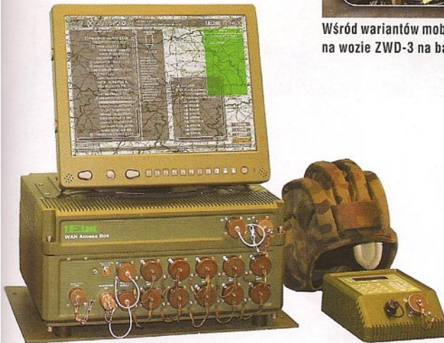
Pojazdowy WAN Access Box wraz z monitorem, a także terminal VoIP członka załogi (zdjęcie z prawej).
