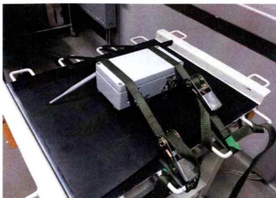
Rysunek 5. Moduł Komunikacji – testy wibracyjne [3]
