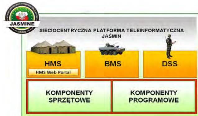
Rysunek nr 2. Elementy składowe sieciocentrycznej platformy teleinformatycznej Jaśmin.
