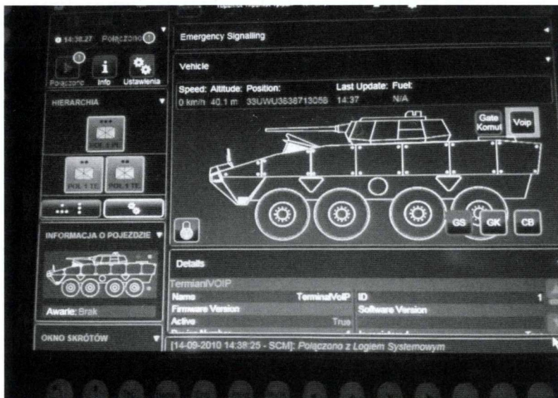
Rys. 8. Widok zobrazowania mapowego w systemie BMS C3IS Jaśmin w wersji 1.6. Widać sytuację z ćwiczenia NATO Combined Endeavor 2010, które odbyło się w Niemczech i Polsce – zobrazowanie graficzne pojazdu, na którym system jest zainstalowany wraz ze stanem funkcjonujących na nim urządzeń (w pasku ponad graficznym zobrazowaniem pojazdu widać również dane o pojeździe – jego prędkość, wysokość n.p.m., położenie).
