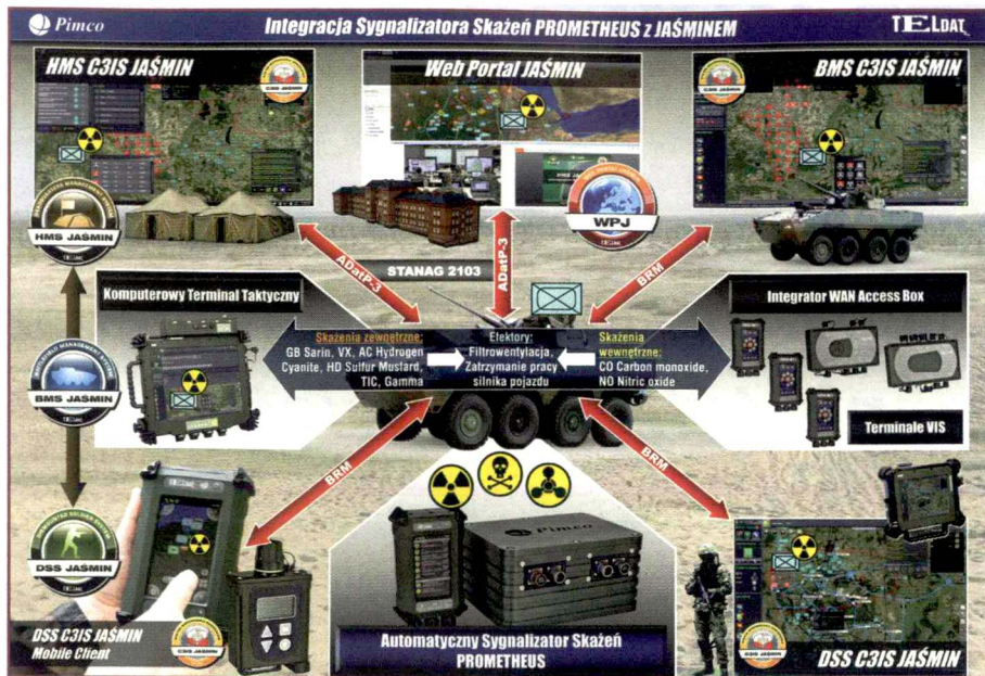
▲ Schemat ilustrujący funkcjonalność rozwiązania polegającego na integracji sygnalizatora skażeń Prometheus i platformy teleinformatycznej Jaśmin .
