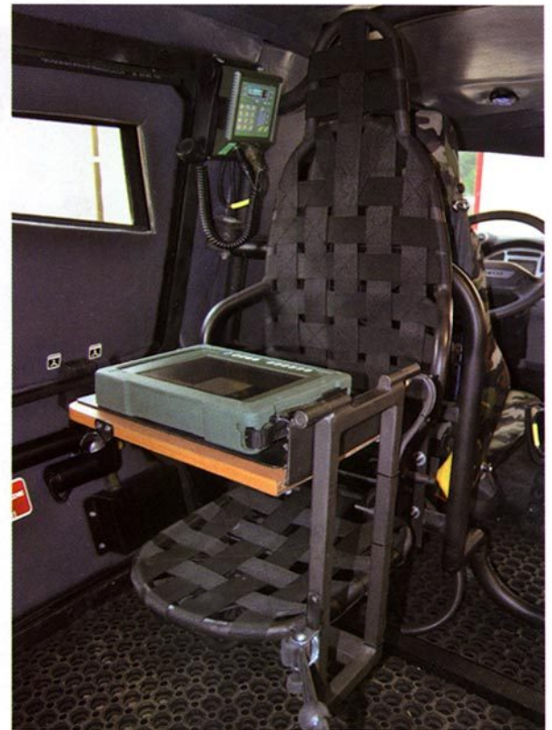
Stanowisko pracy osoby funkcyjnej z wynośnym terminalem taktycznym i terminalem VoIP (po prawej).
