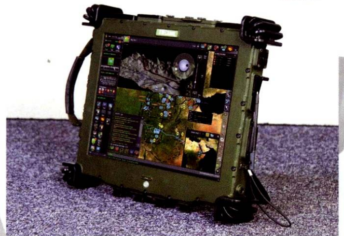
Terminal T4 to urządzenie o wysokiej odporności mechanicznej i klimatycznej, spełniające wymagania dla grupy N.14 polskich norm obronnych.
