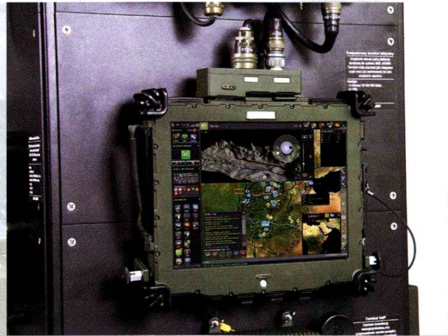
Terminal T4 zamontowany w pojazdowej stacji dokującej. T4 terminal mounted in vehicle docking station.
