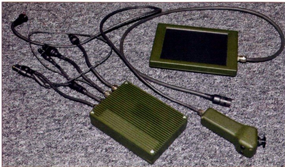
↑ Komputerowy terminal taktyczny, manipulator HID oraz 6" panel dotykowy wraz z wiązkami okablowania. Urządzenia Teldatu, dzięki zastosowaniu w ich konstrukcji najnowszych rozwiązań, są równie niewielkie, jak analogiczne urządzenia czołowych światowych producentów.
