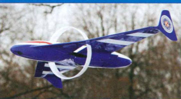
▲ Mini BSL Pszczola może zmieścić się w wojskowym plecaku i być używany do prowadzenia rozpoznania w promieniu 5 km.
