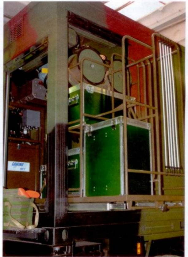
W przedniej części kontenera Jaśmina wyposadzano schowek na zasilacz prądowórczy firmy Camino oraz wyposażenie dodatkowe – w tym szpule z kablami. Wszystko na wysuwanych stelazach, znacząco ułatwiających dostęp.
