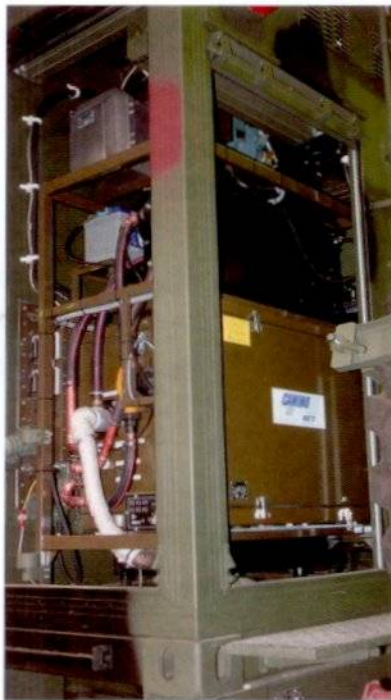
W przedniej części kontenera Jaśmina wyposadzano schowek na zasilacz prądowórczy firmy Camino oraz wyposażenie dodatkowe – w tym szpule z kablami. Wszystko na wysuwanych stelazach, znacząco ułatwiających dostęp.
