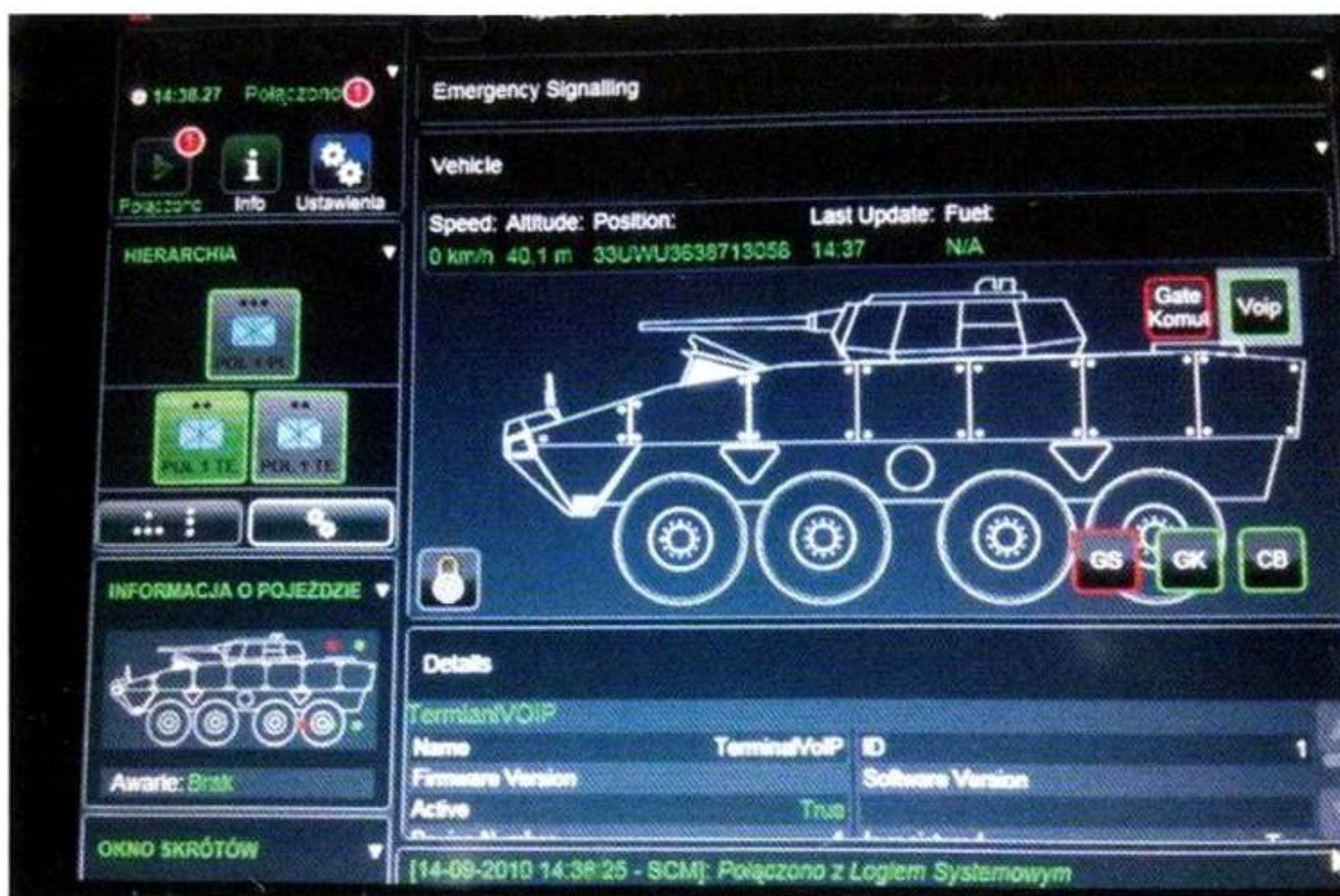
Widok zobrazowania mapowego w systemie BMS C3IS Jaśmin w wersji 1.6. Widać sytuację z ćwiczenia NATO Combined Endeavor 2010, które odbyło się w Niemczech i Polsce – zobrazowanie graficzne pojazdu, na którym system jest zainstalowany wraz ze stanem funkcjonujących na nim urządzeń (w pasku ponad graficznym zobrazowaniem pojazdu widać również dane o pojeździe – jego prędkość, wysokość n.p.m., położenie)
